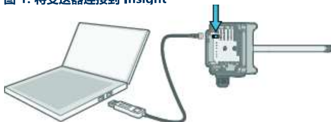
图 1. 将变送器连接到 Insight
